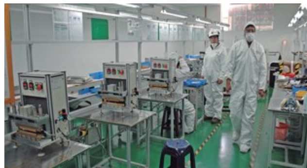
Módulo de sellado de baterías de litio de la planta piloto de baterías de litio en La Palca - Potosí. Gerencia Nacional de Recursos Evaporíticos, 2014.
